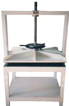
Ручной пресс для бумаги. Металлическая структура покрыта эпоксидной краской 60 микрон. Ручной винт. Платформы защищены от окисления благодаря нанесённому пластиковому покрытию из ПВХ. Максимальное давление 6000 кг. Высота между платформами 45 см.
